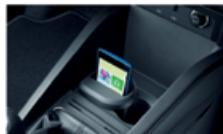
**SmartGate** - Comunicação via wi-fi entre sistemas eletrónicos do veículo e smartphones.
